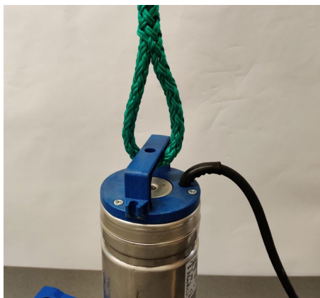
Köyden oikeaoppinen kiinnitys pumpun nostokahvaan.
