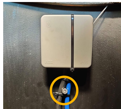
Rasia kiinnitettynä säiliön teleskooppiosaan sinkityllä ruuvilla ja nippusiteillä.
