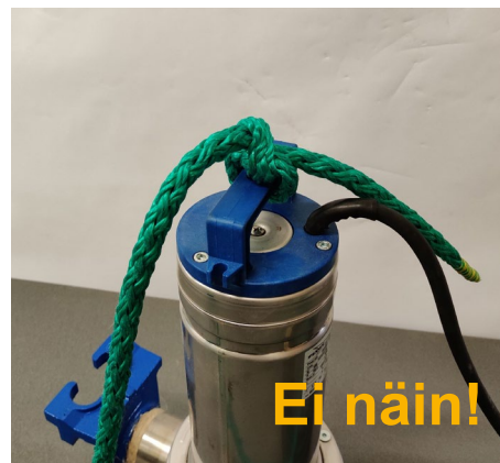
Köysi solmittu liian tiukasti kahvan ympärille.
