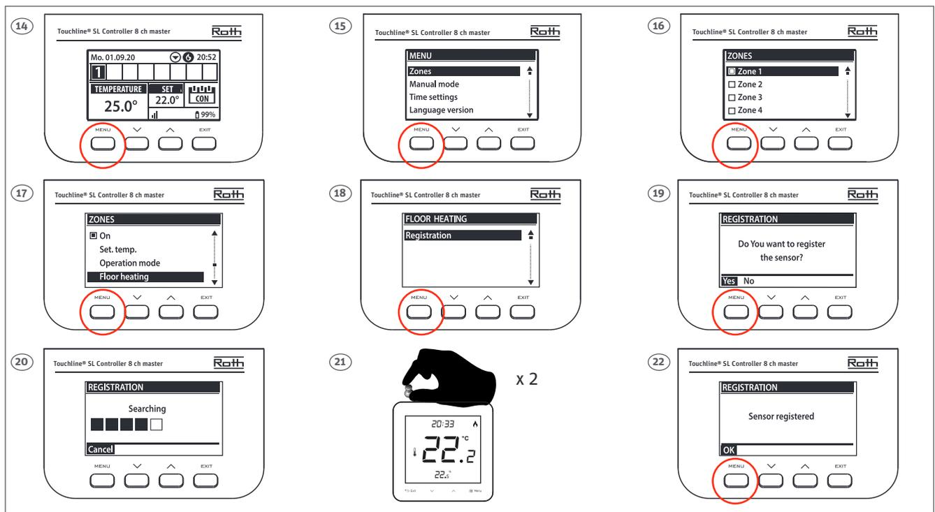
**(DK)** I oversigten på kontrolenheden kan du nu aflæse værdierne for både rumtermostaten (indstillet temperatur 22,0° og aktuel 25,0°) og gulvføleren med aktuel temperatur på (21,0°). Gentag step 14 til 21 for alle andre kanaler (2–8) hvor der ønskes tilsluttet en gulvføler.
