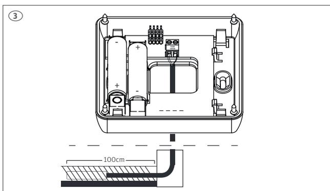
**(DK)** Det er muligt at tilslutte en gulvføler til termostaten (gulvføler ikke inkl.). Tryk forsigtigt ledningerne ind i klemmen og skru dem fast. Føleren skal trækkes i trærør og følerenden placeres lige under øverste gulvbelægning, midt imellem gulvvarmeslangerne.
