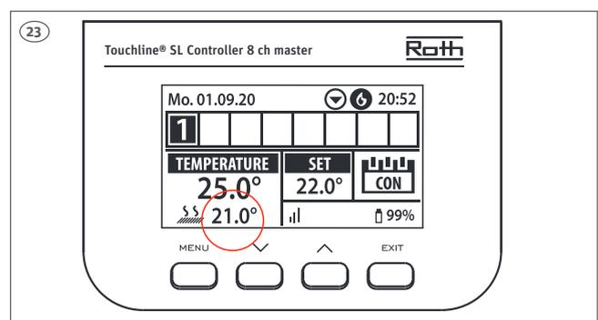
**(DK)** Indstilling af gulvføleren skal udføres på kontrolenheden. Gulvfølerens driftstilstand kan enten indstilles til "beskyttelse af gulv" eller "Komfort".
