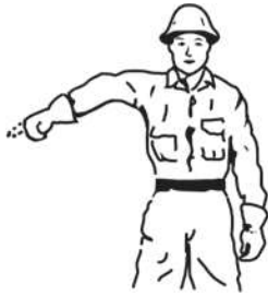
6. KÄYTÄ TARTUNTA Käsi taivutettu, sormet osoittavat alaspäin, avaa ja sulje nyrkki.
