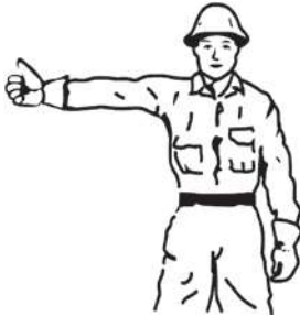
1. NOSTA PUOMIN KÄRKI PYSTYYN Käsi ojennettuna, sormet kiinni, peukalo ylöspäin.
