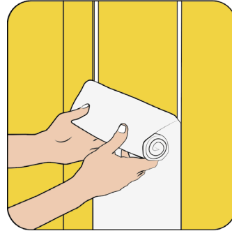
4. Pyöritä kangas rullalle ja kiinnitä suodatin ikkuna-aukon reunoihin alhaalta ylöspäin.
