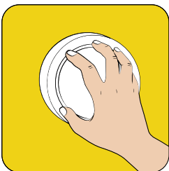
1. Venttiili on tehdasasetuksessa, kun kuulet sitä kääntäessä naksahduksen.
